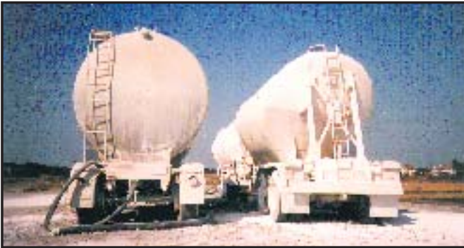
Fig. 7 - Transporte y almacenamiento de la cal.
